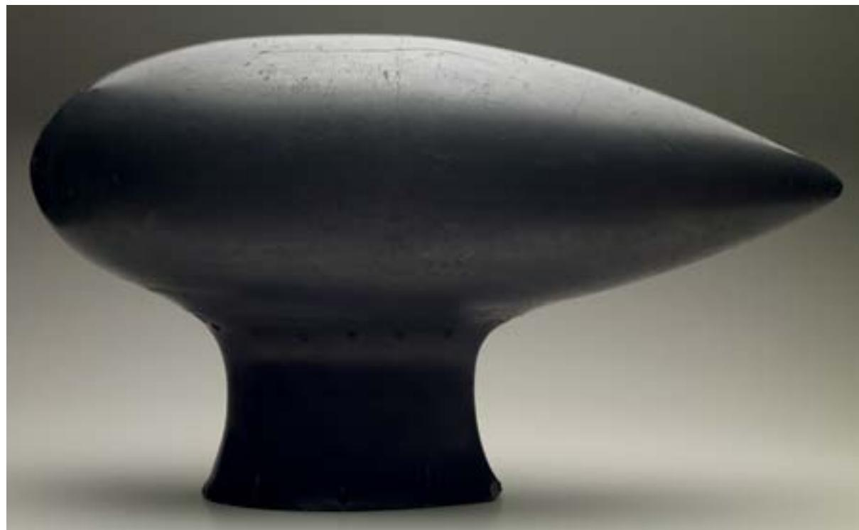
Goniômetro do DC3, EUA, c. 1933 (acima). O equipamento era uma espécie de rádio-antena usada na navegação dos aviões com o objetivo de melhorar o seu desempenho. Também chamados de rádios-gônio, foram colocados no exterior da maioria das aeronaves utilizadas na Segunda Guerra Mundial.
